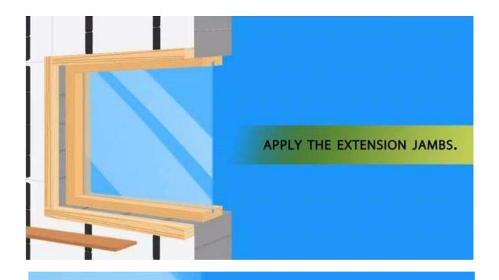
THESE SHOULD OVERHANG THE FRAME BY A 1/2" SO THEY SIT FLUSH WITH THE DRYWALL.
